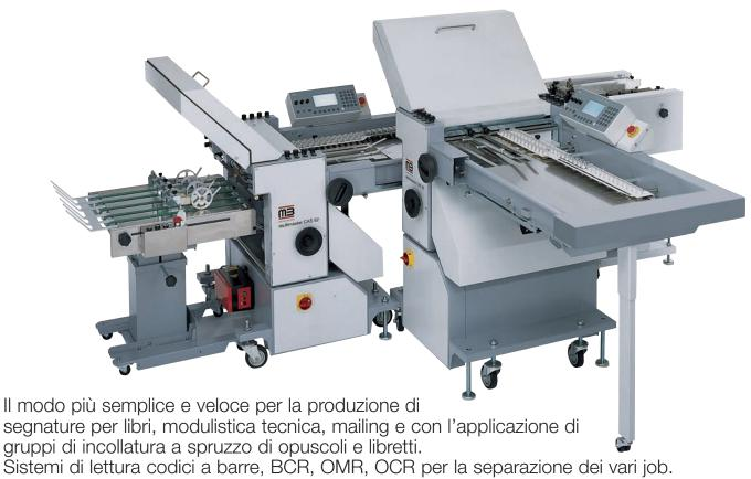
Sistemi di lettura codici a barre, BCR, OMR, OCR per la separazione dei vari job. Accessori di perforazione, cordonatura, taglio, barre antistatiche.
