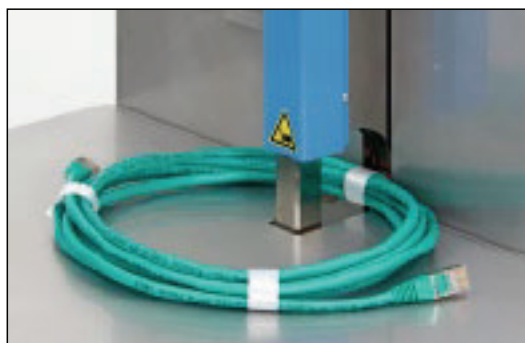
Arco chiuso (svolgimento della fascettatura) Arch closed (banding stage)
