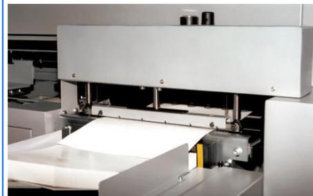
Il sistema di cordonatura su basa sul principio di lama a battuta, il più indicato per la stampa digitale. Garantisce una cordonatura estremamente precisa e senza danneggiare le copertine anche con supporti leggeri, pesanti o laminati. Sistema pneumatico con gestione pressione e tempistiche da pannello touch. Fino a 8 cordonature positive, opzionale kit di cordonatura positiva/negativa.
